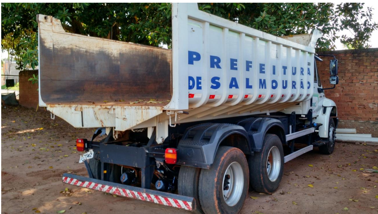
Imagem 43: principal caminhão basculante utilizado na coleta de resíduos da construção civil.
