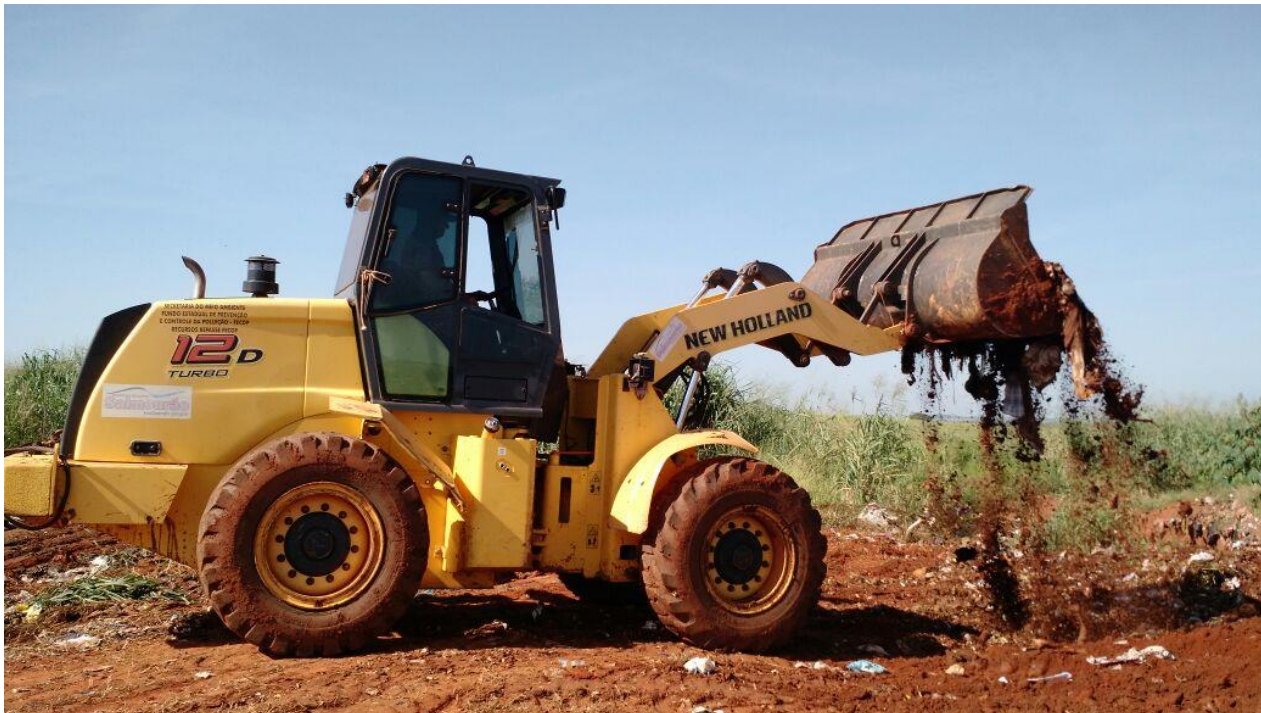
Imagem 26: pá-carregadeira utilizada no aterro em valas.
