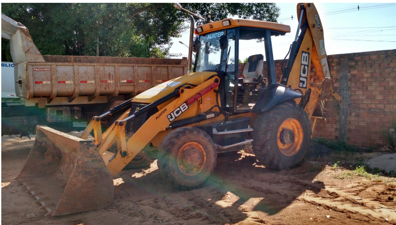
Imagem 27: pá-carregadeira e retroescavadeira utilizada no aterro em valas.
